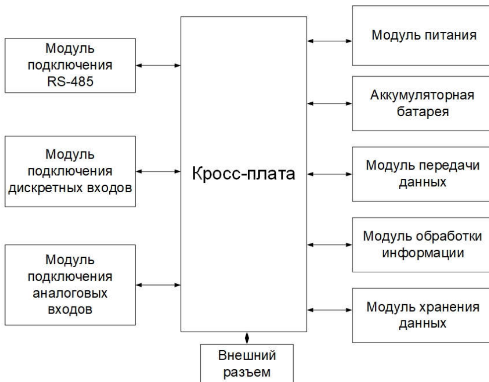
Рисунок 4.7 – Структурная схема автономной станции мониторинга пространственно-распределенных объектов
