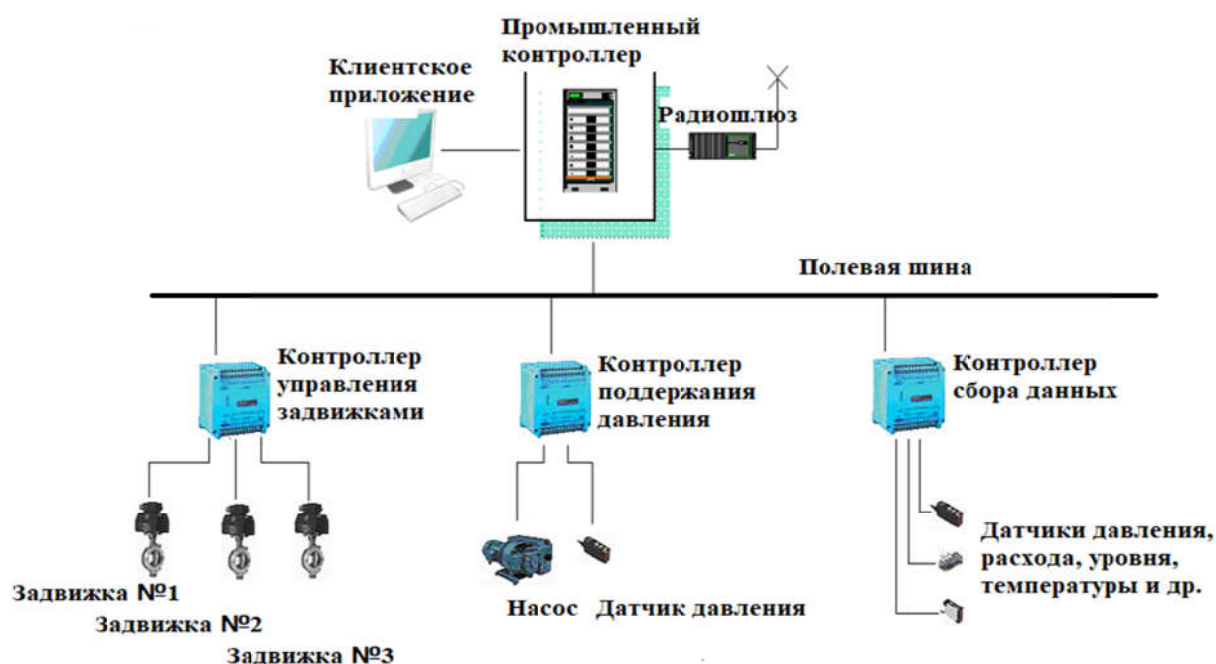
Рисунок 5.2 – Схема АСУ ТП на водопроводных узлах и ПНС системы водоснабжения города
