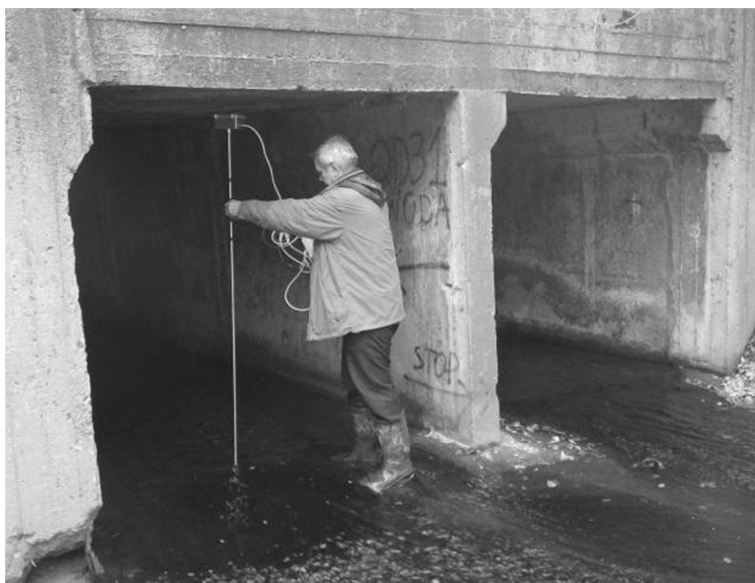
Рисунок 4.6 – Измерение скорости потока на выходе галерей водосбросового сооружения Третьего городского пруда
